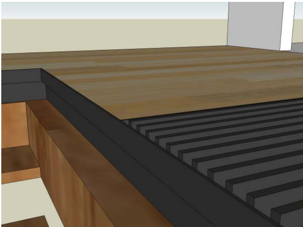
Détail du cadre : joint creux
